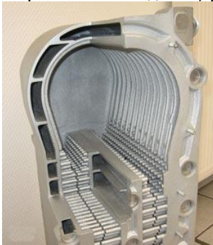
Рисунок 108. Типовая алюминиевая отливка завода MGG по Сейатцу-процессу на линии HWS-Sinto. Корпус теплообменника конденсатора, удостоенный награды "Aluminium Award 2000". Вес 32,9 кг
