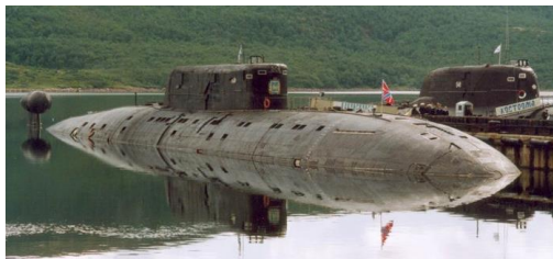
Рисунок 128. Титановые корпуса подводных лодок проектов 945 «Барракуда» и 945А «Кондор»;
